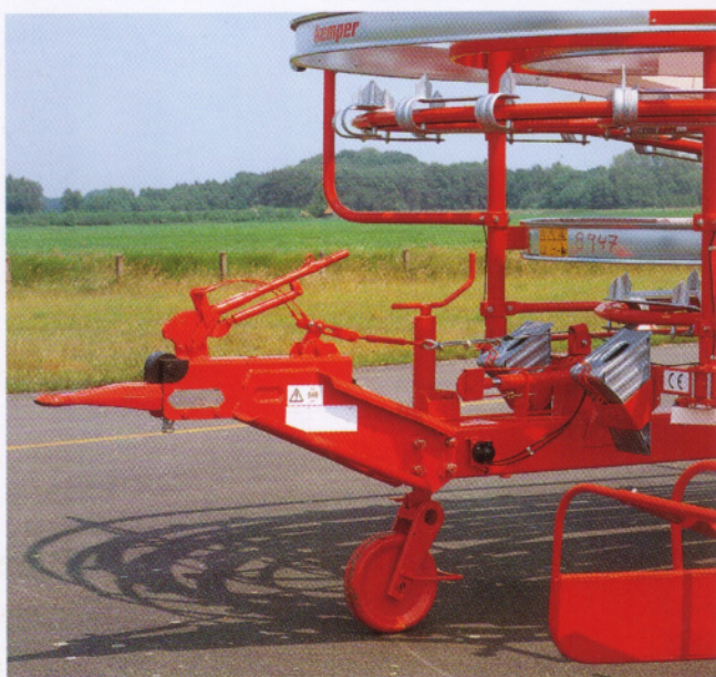
Zugdeichsel – Auflaufbremse mit Rückfahrautomatik
