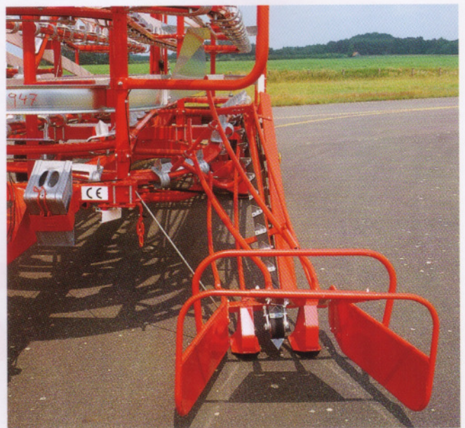
Optimale Boden Anpassung der höhenbeweglichen Aufnahmevorrichtung durch Federentlastung. Hydraulische Bedienung.
